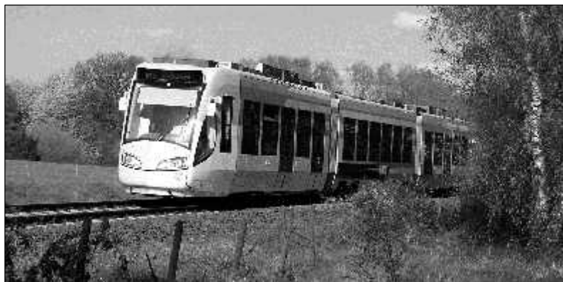
Zwei-Kraft-Niederflurfahrzeug der Firma Alstom. Die RegioTram verfügt sowohl über einen Dieselmotor als auch über einen Elektroantrieb.
