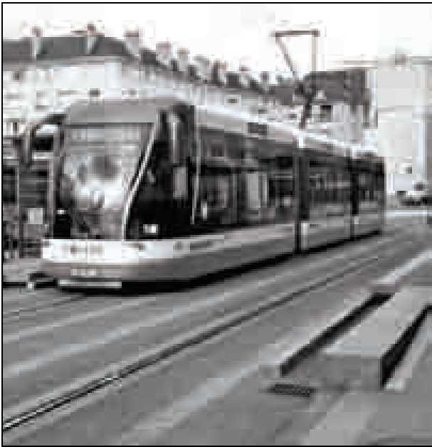
Die Tramway de Caen ist ein Spur-Obus. (Foto: Wolfgang Brauer)
